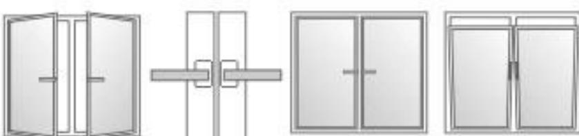
Приведение створки из положения «открыто» в положение «откинуто». Прикрыть створку и прижать ее к раме, далее перевести ручку из положения «открыто» (ручка установлена строго горизонтально в сторону петель) в положение «откинуто» (ручка установлена строго вертикально вверх).
