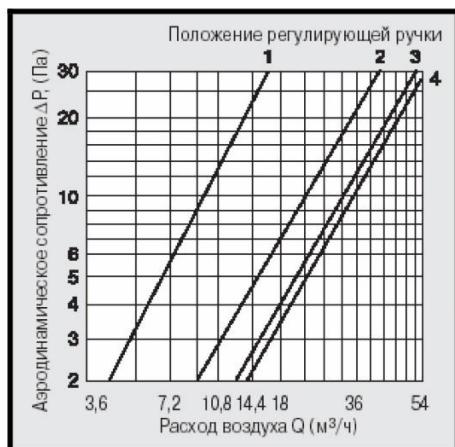
В соответствии с аэродинамическими характеристиками производительность клапана зависит от создаваемого вытяжкой разряжения:
