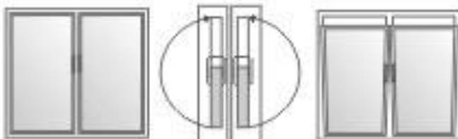
Приведение створки из положения «закрыто» в положение «откинуто» (режим «форточки»). Повернуть ручку вверх и установить её в строго вертикальное положение.
