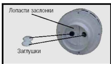
Необходимость в минимальном проветривании может возникнуть при длительном отсутствии людей в помещениях, чтобы исключить «застойный дух». В лопастях заслонки имеются заглушки, которые можно удалить. В этом случае при закрытии заслонки будет обеспечено минимальное проветривание.
