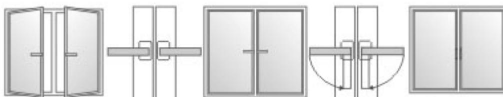
Приведение створки из положения «открыто» в положение «закрыто». Прикрыть створку и прижать ее к раме, далее перевести ручку из положения «открыто» (ручка установлена строго горизонтально в сторону петель) в положение «закрыто» (ручка установлена строго вертикально вниз).
