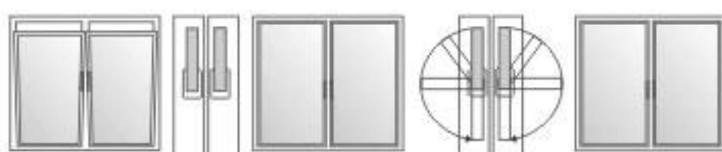
Приведение створки из положения «откинуто» в положение «закрыто». Прижать створку к раме, далее перевести ручку из положения «откинуто» (ручка установлена строго вертикально вверх) в положение «закрыто» (ручка установлена строго вертикально вниз).
