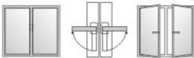
Приведение створки из положения «закрыто» в положение «открыто». Повернуть ручку строго горизонтально в сторону оконных петель.
