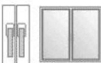
*Положение «закрыто». При закрытой створке ручка повёрнута вниз и находится строго в вертикальном положении.*
